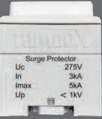
D Sınıfı 2 Kutuplu Parafudr (3/5kA) YM1T3
